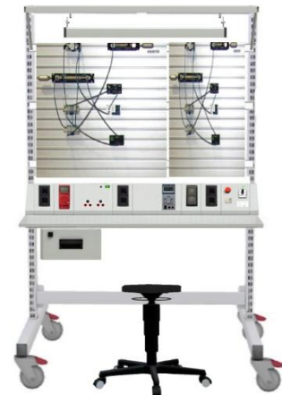
TRTA4 -harjoitusvaunu, jossa asennussarja TRAKP pneumatiikan asennuslevylle sekä EP15L12 - laitepaneeli laitteineen
