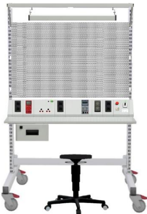
TRTA4 -harjoitusvaunu, jossa rei'itetty metallilevy TRAM sähkötekniikan komponenttien asennukseen, sisältäen 100 kpl muoviholkkeja sekä asennusruuveja
